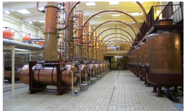
Le mélange écorce d'orange et alcool s'évapore par les cols de cygne pour rejoindre les tours de refroidissement situées à gauche de la photo ci-dessus. Leur rôle est de transformer cette vapeur en liqueur (COINTREAU).
